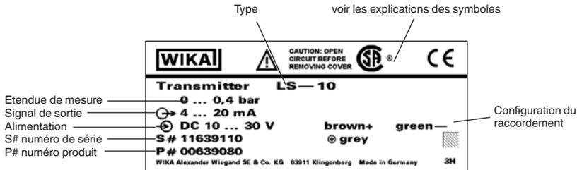
Si le numéro de série devient illisible à cause de dommages mécaniques ou de peinture, aucune traçabilité n'est plus possible.
