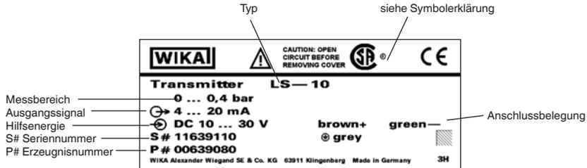
Wird die Seriennummer durch mechanische Beschädigung oder Übermalen unleserlich, ist eine Rückverfolgbarkeit nicht mehr möglich.
