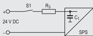
R<sub>S</sub> = 22 ohmios (47 ohmios con contactos 10 VA)
