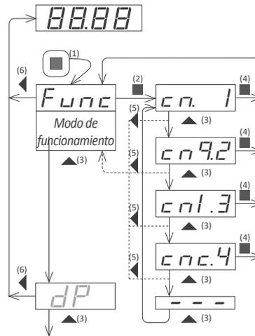
Ejemplo de desplazamiento dentro del 'menú de configuración'.
