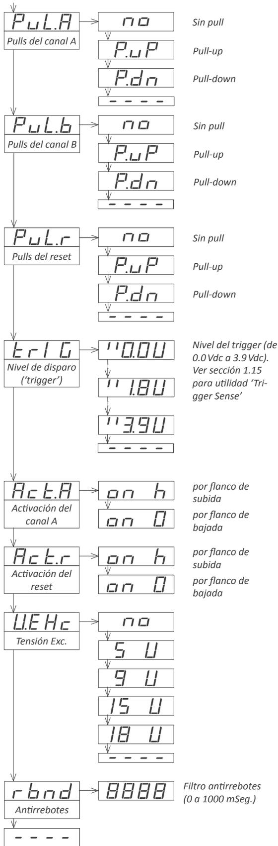
• **'Puls del canal A' ('PuL.A')** - permite activar las resistencias de pull del canal A. Seleccionar **'P.uP'** activa las resistencias de pull-up (necesarias para sensores NPN). Seleccionar **'P.dn'** activa las resistencias de pull-down (necesarias para sensores PNP). La selección de resistencia de pull configura el nivel de disparo ('trigger') a 2,5Vdc.
