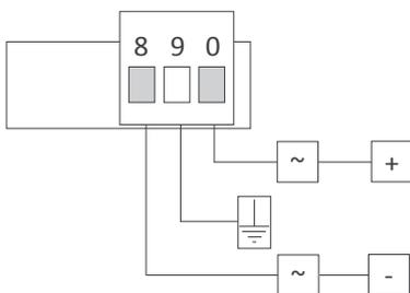
Fusibles - para mantener conformidad con la normativa de seguridad 61010-1, añadir a la línea de alimentación un fusible de protección como elemento de desconexión del equipo, fácilmente accesible al operador e identificado como dispositivo de protección.
