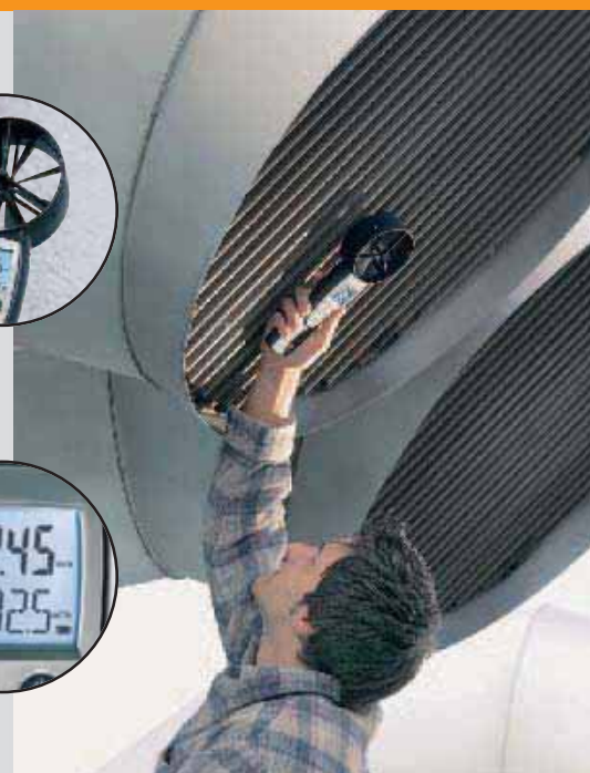
Medición del caudal en un conducto de salida con una sonda molinete de Ø 100 mm
