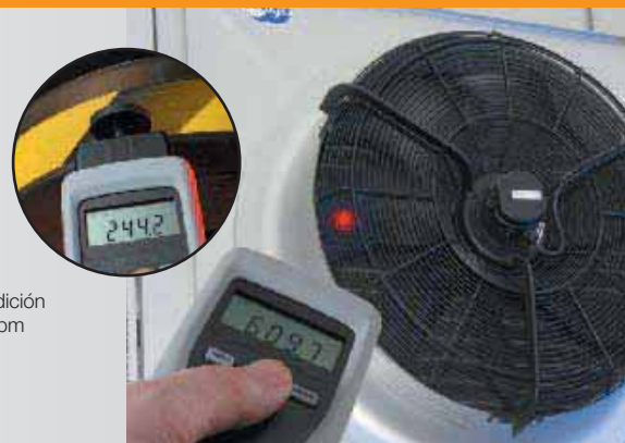
testo 465 y testo 470, medición sin contacto (óptica) de rpm en partes rotativas
