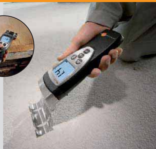
Rápida y sencilla - Comprobación de la humedad en pavimentos. Medición en varios puntos a lo largo de la superficie para obtener resultados más fiables.
