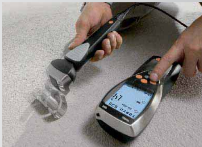
Deteminación de la humedad en cementos de forma rápida y sencilla. La medición a la vez en varias zonas de una superficie con la sonda de múltiples láminas permite una toma de valores de gran fiabilidad.
