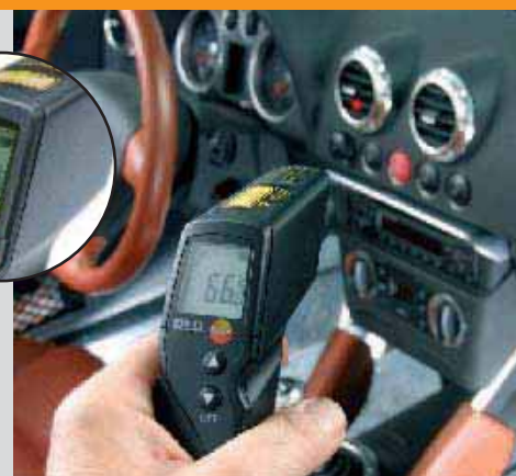
Control de la temperatura en un climatizador
