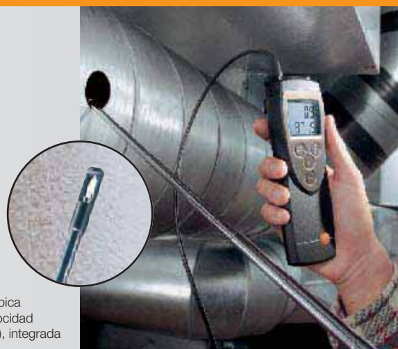
testo 425, p.ej. para controlar el caudal del aire de salida
