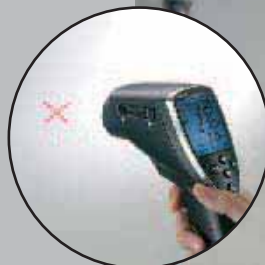
Optica zoom 1: larga distancia 75:1 (16 mm, distancia 1200 mm) con indicador láser en cruz
