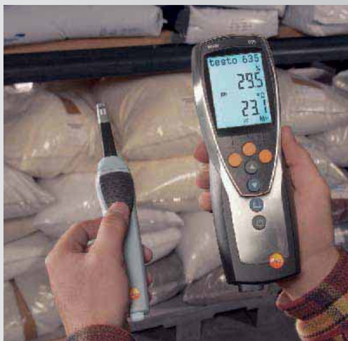
Medición sin cables de la temperatura y la humedad en un almacén, con empuñadura por radio y cabezal de sonda de humedad acoplable
