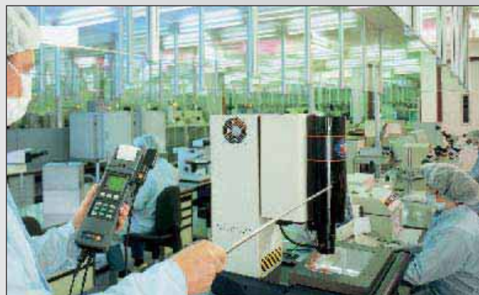
Comprobación de la velocidad utilizando la sonda de hilo caliente Modelo: 0635 1041
