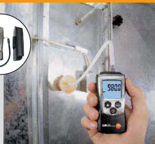
Medición de la presión absoluta para determinar la compensación de presión absoluta cuando se mide velocidad con un tubo Pitot
