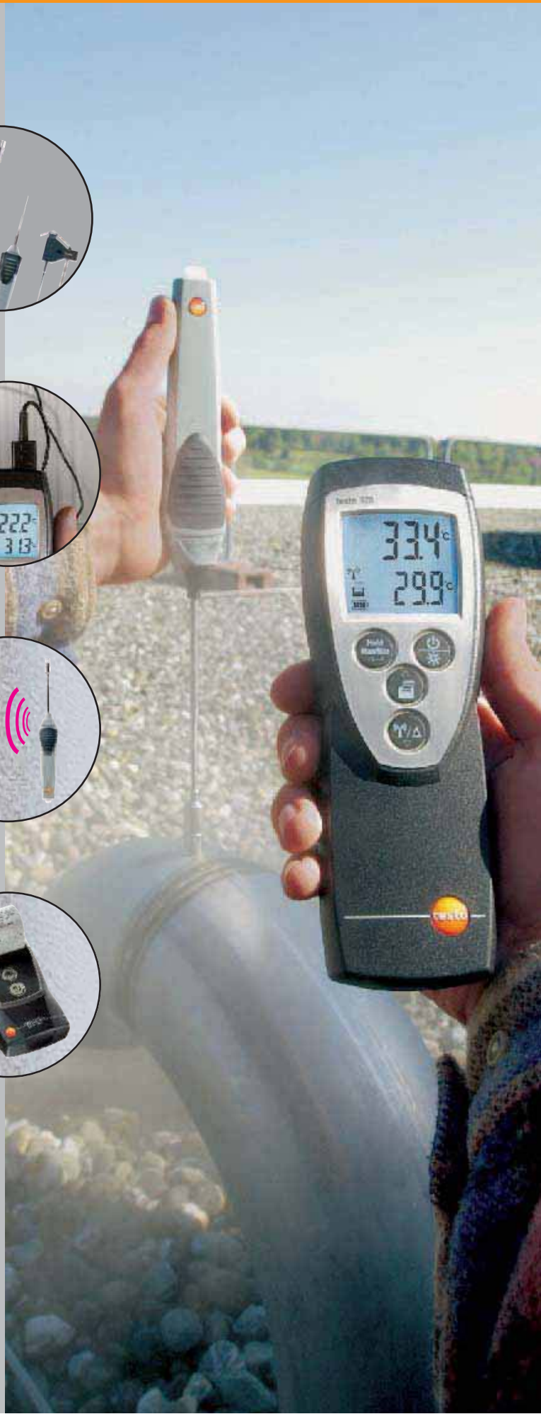
Impresión in situ con la impresora rápida Testo Impresión cíclica de las lecturas, p. ej., una vez por minuto (testo 922)
