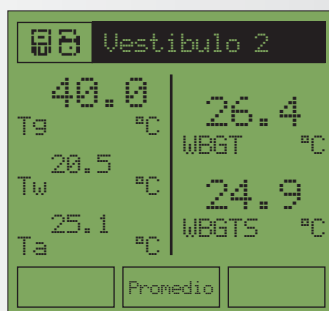
Visualización de los índices calculados WBGT y WBGTS directamente en el visualizador
