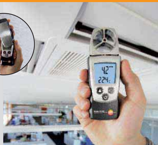
Medición de velocidad en una salida de ventilación con una sonda de molinete de 40 mm
