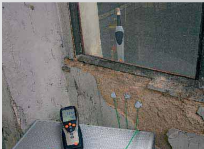
Medición del valor U en un muro en reparación con la sonda de valor U y una sonda inalámbrica de humedad/temperatura (también se puede medir con una sonda de temperatura)
