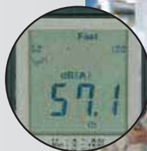
testo 815, Control del ruido producido por sistemas de ventilación
