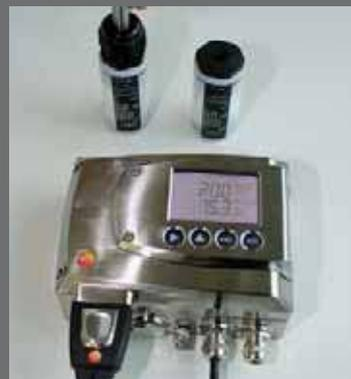
Reajuste con soluciones salinas de calibración
