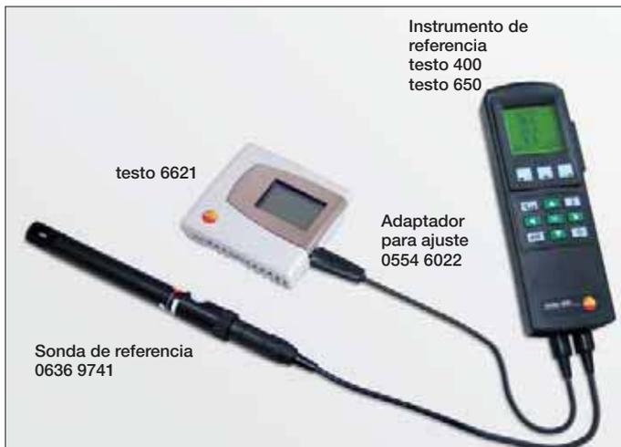
Ajuste in situ: rápido y preciso gracias al conector externo
