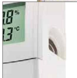
Los datos de medición se analizan y se ajusta el transmisor a través de la interfaz externa y el software P2A
