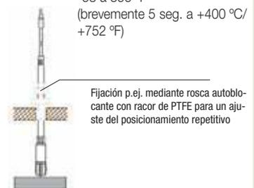
**Tipo 18** Sonda de superficie (resorte de banda termopar) con rosca M 12x1 (p.ej. para brazo robotizado)
