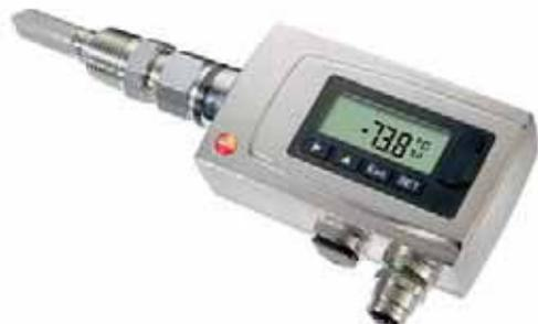
El transmisor testo 6781 está diseñado especialmente para la medición de trazas de humedad en aire comprimido y en aire seco (p.ej. en secadores de granza). Mediante la norma ISO 8573 se categorizan 7 clases de aire comprimido y se necesitan secadores por adsorción de altas prestaciones para cumplir con las clases más exigentes 1 y 2.
