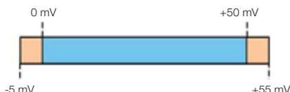
Los valores máximos en °C corresponden a los voltajes máximos de entrada (-5 mV...+55 mV) que el transmisor puede procesar. (Voltaje termoelectrónico de acuerdo a IEC 584-1)
