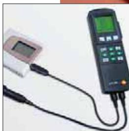
Rápido y preciso ajuste in situ con los instrumentos portátiles de referencia testo 400/testo 650
