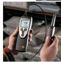
Sonda y empuñadura con cable (opcional) para mediciones en lugares de difícil acceso
