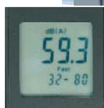
Ponderación frecuencial de la lectura actual Tiempo de respuesta Rango de medición por secciones
