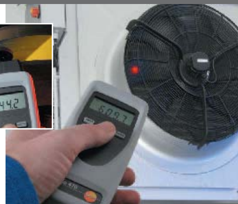
testo 465 y testo 470, medición del número de revoluciones sin contacto (óptica) en piezas en rotación
