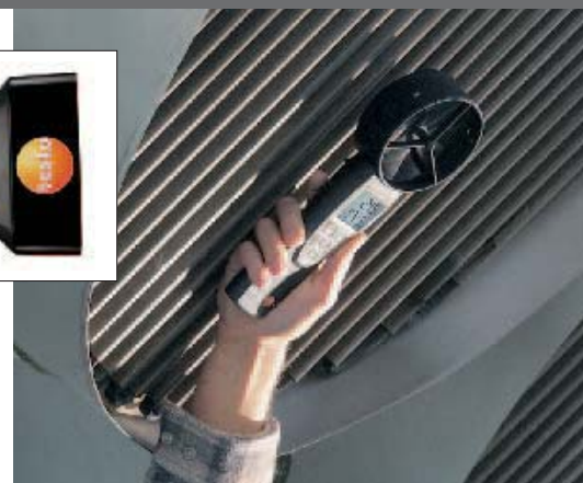
Medición del aire de salida con el testo 417 y sonda de molinete de 100 mm
