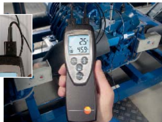
Control de la temperatura diferencial en compresores con las sondas abrazadera para tuberías
