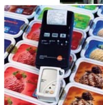
testo 175-H1 sin visualizador. Los datos se documentan por medio de la impresora rápida.
