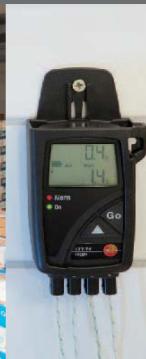
Registro simultáneo de la temperatura en hasta 4 lugares diferentes
