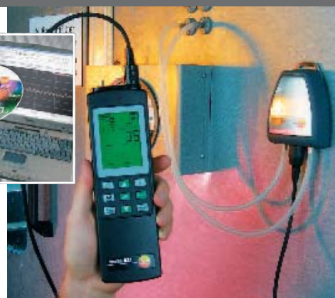
Observación del filtro con sonda de 100 Pa externa
