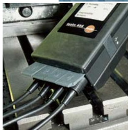
Posibilidad de conectar hasta 4 sondas diferentes por logger
