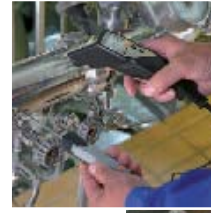
testo 830-T4: Ajuste de la emisividad mediante sonda de temperatura externa
