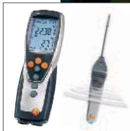
Medición inalámbrica con sondas por radio de ambiente, inmersión y penetración
