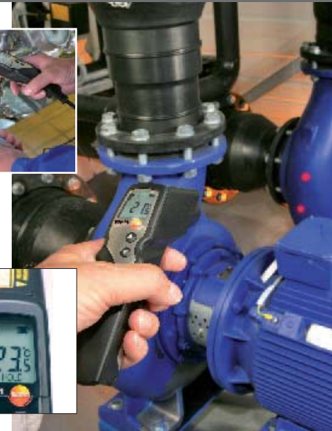
Monitorizar por infrarrojos la temperatura de una tubería con el testo 830-T4. Los indicadores láser marcan el lugar de la medición
