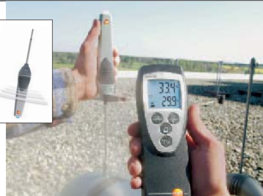
Control de la temperatura en conductos de extracción
