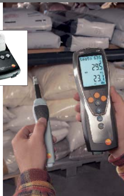
Medición sin cables de la temperatura y la humedad en un almacén, con empuñadura por radio y cabezal de sonda de humedad acoplable
