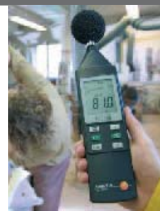
testo 816, Control del nivel de ruido ambiental en lugares de trabajo
