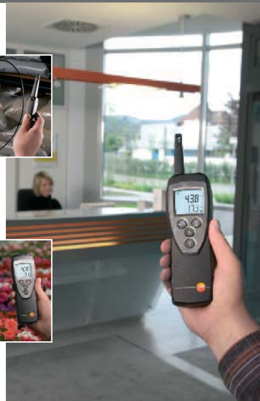
Control del ambiente en interiores con sonda de humedad integrada
