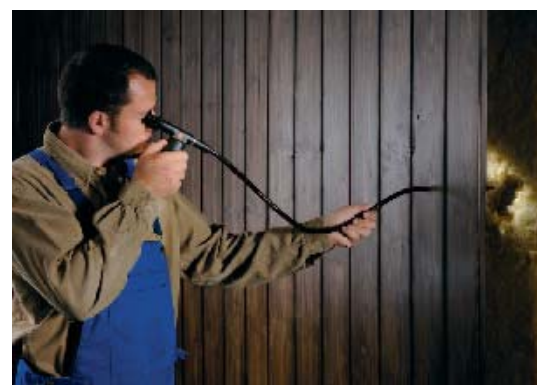
Comprobación de aislamientos mediante la estabilidad del tubo Dekabon
