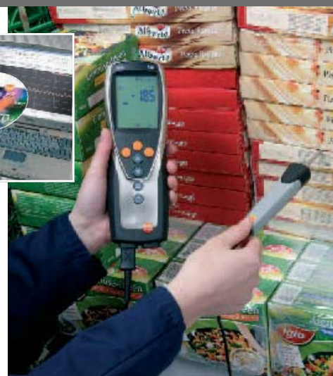
Control de la temperatura en una cámara refrigeradora
