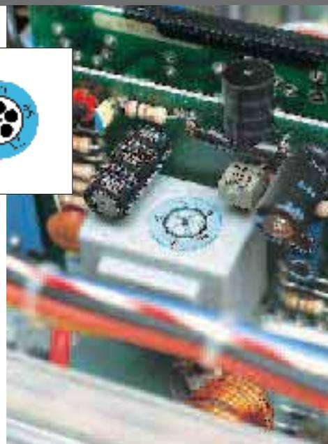
Control de temperatura, por ejemplo, en componentes eléctricos y electrónicos, válvulas, etc.
