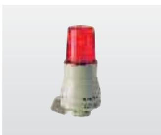
Módulo de alarma (visual y acústica), conectable a un relé de alarma de la base, diam. 70 x 164 mm, 24 VCA/CC ó 320 mA, continuo: en rojo, tono continuo: zumbador aprox. 2.4 kHz (se necesita el alimentador 0554 1749)
