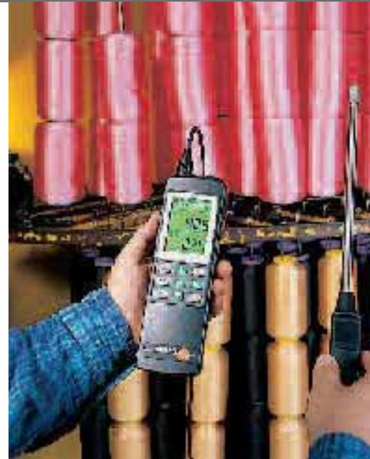
Medición de humedad hasta +180 °C en sistemas de secado
