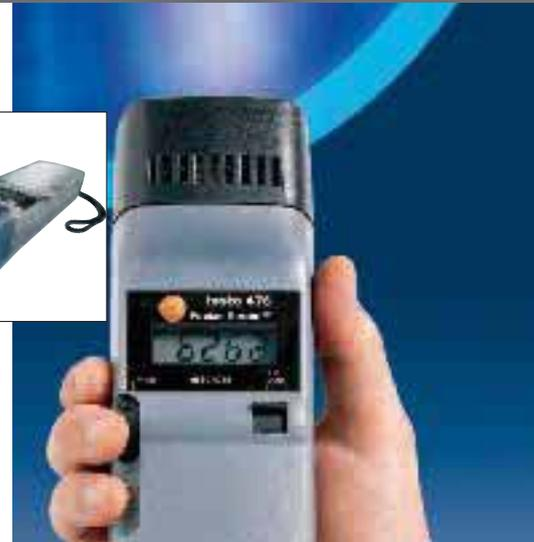
Medición de rpm en ejes
