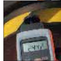
Medición mecánica de rpm
