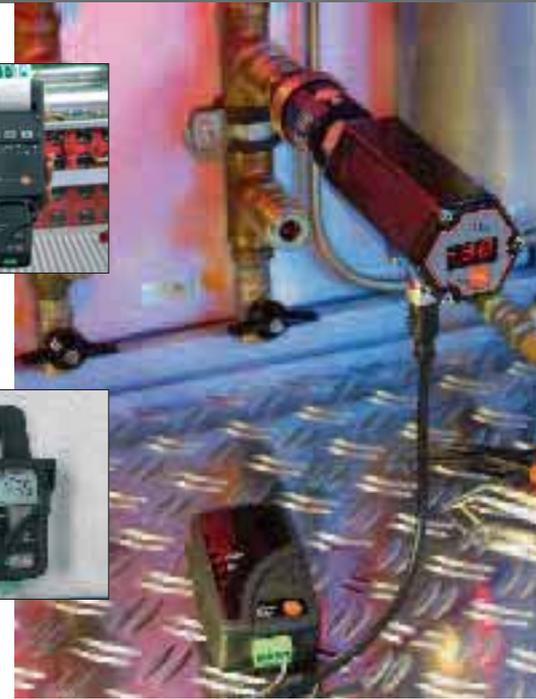
Registro de la corriente de la señal de un transmisor con el testo 175-S1 (sin visualizador)
