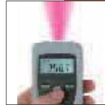
Medición de rpm sin contacto (óptica)
