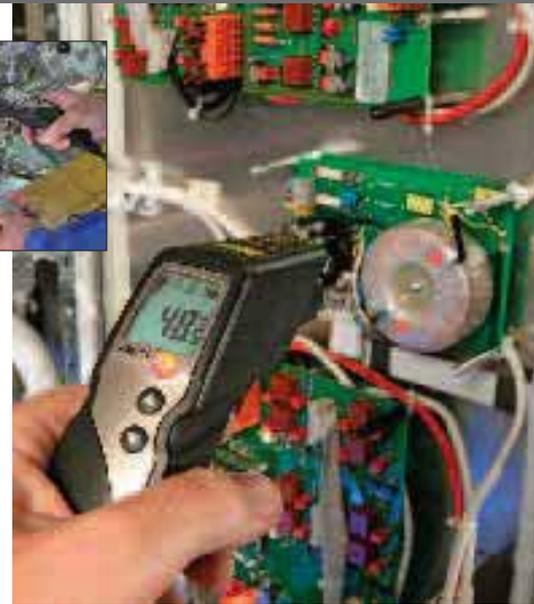
Control de la temperatura de componentes electrónicos
