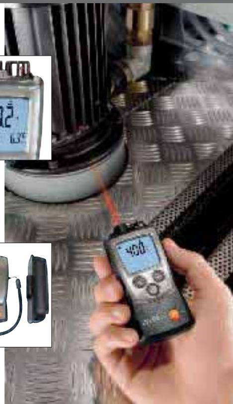
Comprobación de la temperatura de superficie, p.ej. en motores eléctricos
