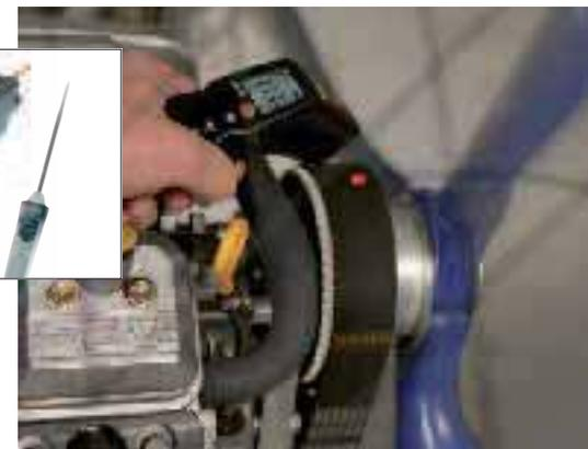
testo 830-T3, especial para superficies de diámetro reducido, por ejemplo, para medir la temperatura en cintas V
