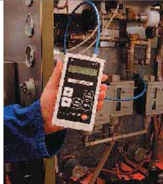
Medición de la presión absoluta en una autoclave en medicina
