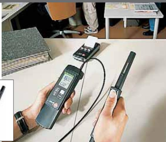
Control de la calidad del aire interior, p.ej. en oficinas y rápida impresión de datos en la impresora testo
