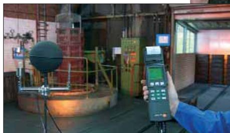
Sonda BGT para medición del estrés térmico
