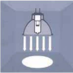
La intensidad de luz es una medida de la luz que incide en una superficie. Unidad de medición: Lux
