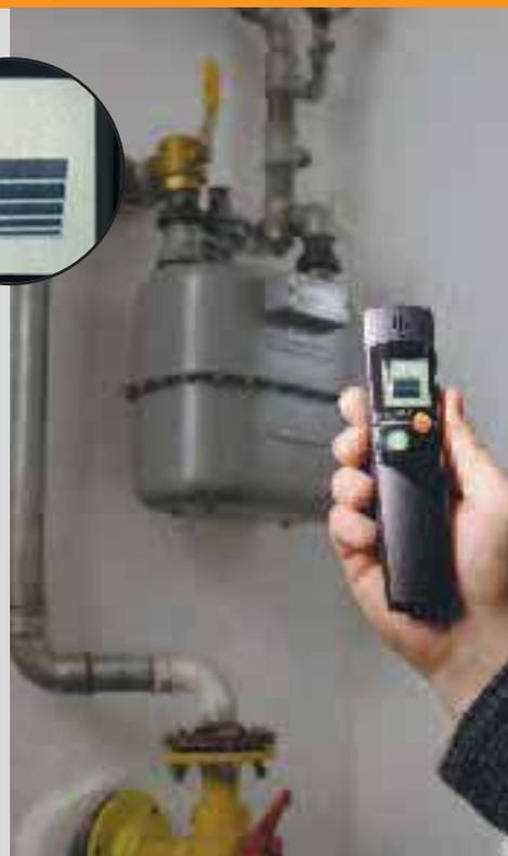
Señal acústica de concentraciones peligrosas de gas p.ej. en conexiones de tuberías de gas.
