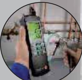
Test de presión en tuberías de agua sanitaria y residual.
