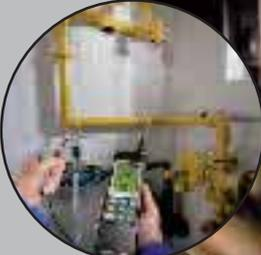
Tests de carga, estanqueidad y funcionalidad por caída de presión en tuberías de gas como test de carga para instalaciones nuevas
