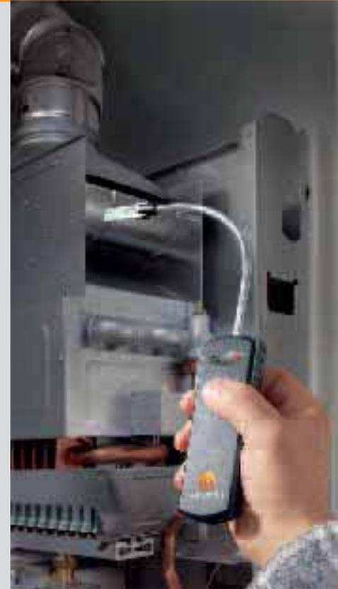
Determina si los gases de combustión se han expulsado completamente de la caldera
