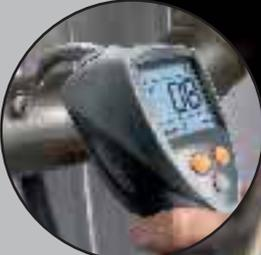
Medición automática – medición totalmente automatizada del nº de opacidad en menos de un minuto.
