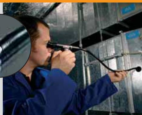
Inspección en conductos de aire acondicionado, con funda de cuello de cisne de flexibilidad media
