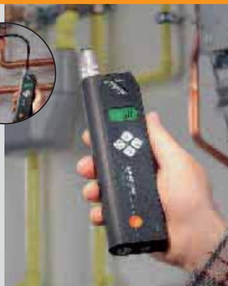
Detección de gas y detección de fugas en tuberías e instalaciones de gas
