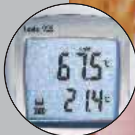
Muestra los valores mín/máx en el visualizador iluminado
