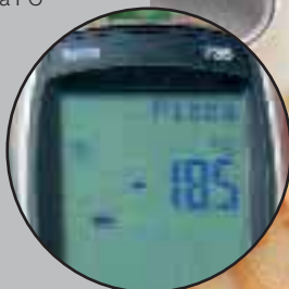
Muestra el sitio y el parámetro. Se pueden almacenar hasta 99 nombres de producto en el instrumento.
