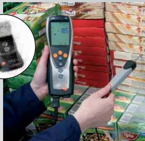
Control por muestreo de cámaras frigoríficas para productos congelados
