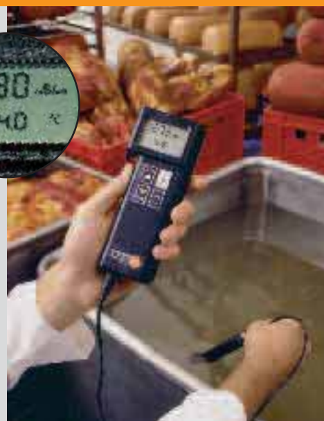
Medición del nivel de sales (NaCl) de alimentos en salmuera
