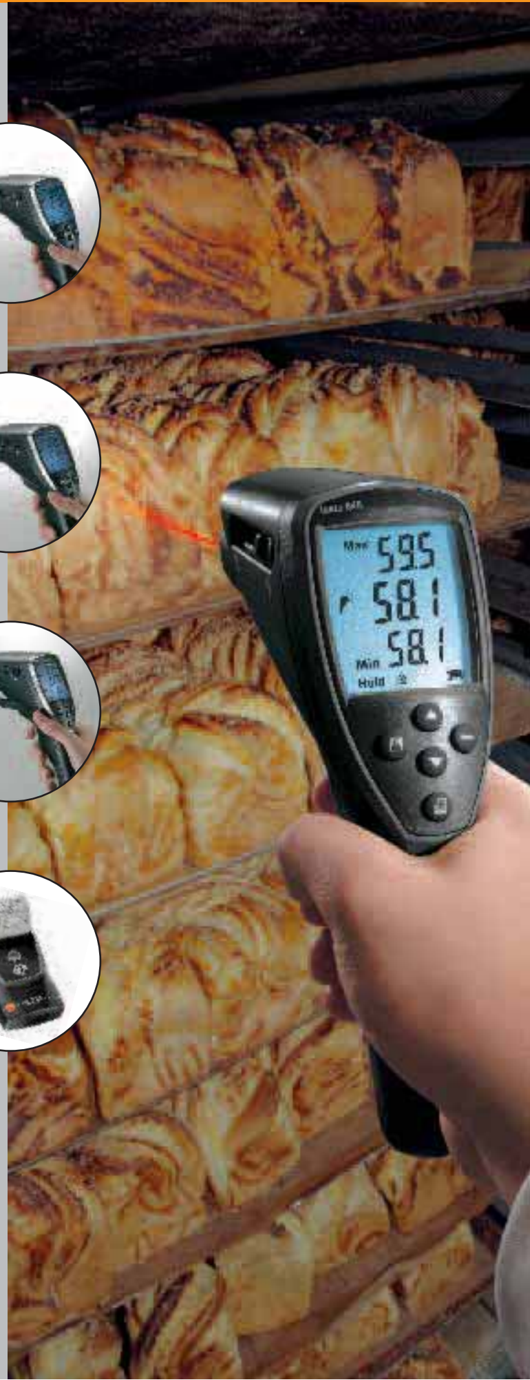
Optica zoom 1: Campo lejano 75:1 (16 mm, distancia 1200 mm) con indicador láser en cruz
