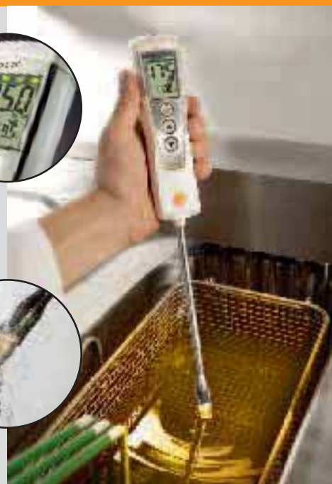
Monitorización del aceite de cocinar en una freidora
