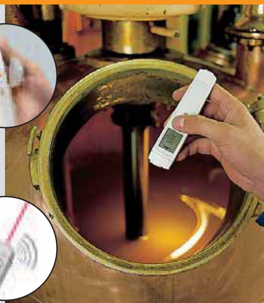
Comprobación de la temperatura durante la licuación de rellenos para chocolates
