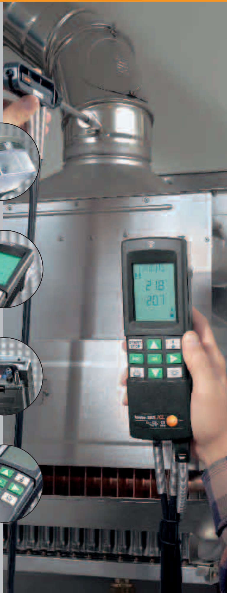
Medición de la presión de gas con conector adicional para +/-
