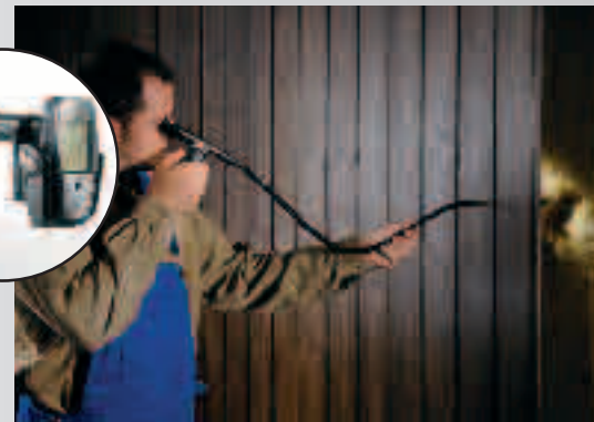
Comprobación en aislamientos mediante la estabilidad del tubo Decabon
