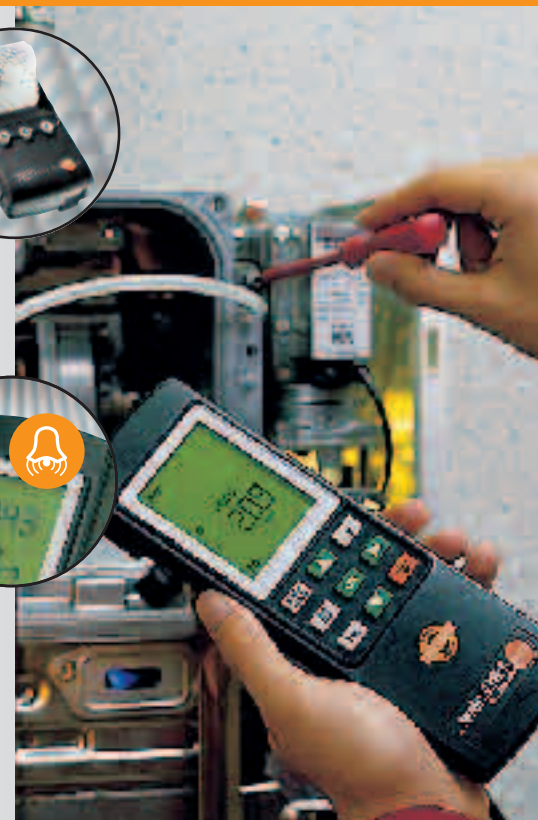
Medición de presión diferencial en unidades de calefacción
