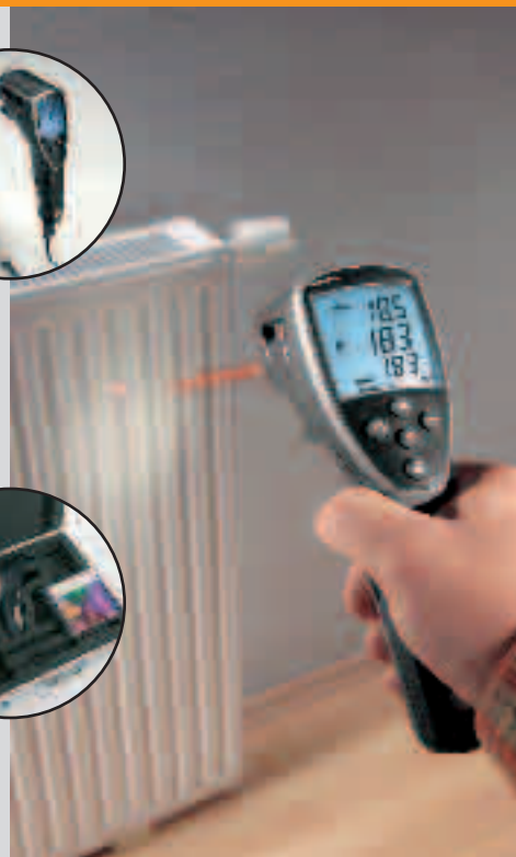
Comprobación de la temperatura de superficie
