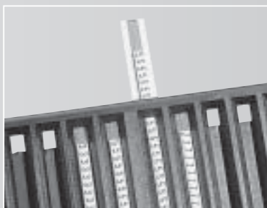
Las bandas de identificadores son introducidas en la placa auxiliar.
