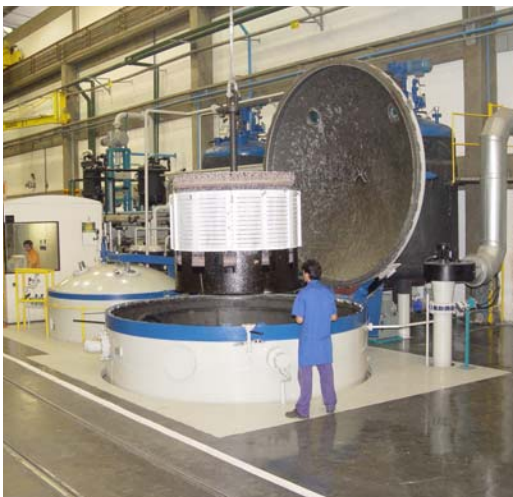
Impregnación al vacío - VPI
