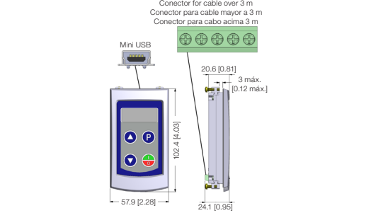
Figure A3: CFW300-KHMIR dimensions in mm [in] and connectors location Figura A3: Dimensiones del CFW300-KHMIR en mm [in] y localización de los conectadores Figura A3: Dimensões do CFW300-KHMIR em mm [in] e localização dos conectores
