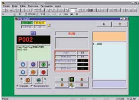
El SuperDrive es un software en entorno Windows que permite parametrizar, controlar y monitorear los convertidores de frecuencia WEG en un PC a través de la comunicación serie (RS-232 o RS-485). Además, permite hacer el "back-up" de los parámetros, documentación del proyecto y monitoreo "on-line" de los parámetros.
