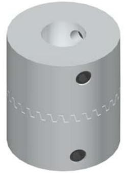
Los acoplamientos UNION son acoplamientos rígidos simples, de dos piezas mecanizados en acero. Son aptos para transmisiones que requieren pares elevados y donde no hay desalineaciones entre ejes.
