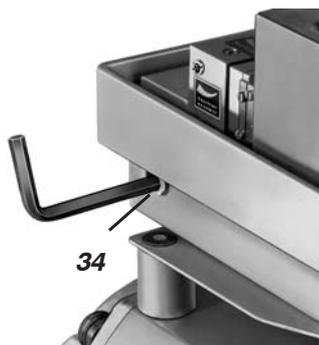
Fig. 19: Fijar los tornillos del balancín
