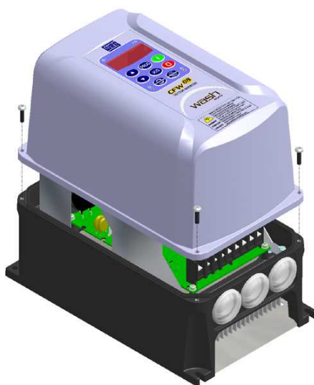
Figura 2.2 - Procedimiento para la extracción del cerramiento frontal CFW-08 Wash
