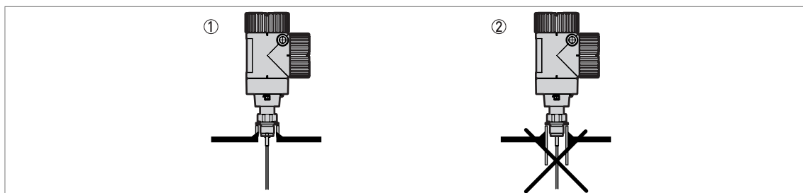
Figura 3-8: Casquillos para conexiones de proceso roscadas
