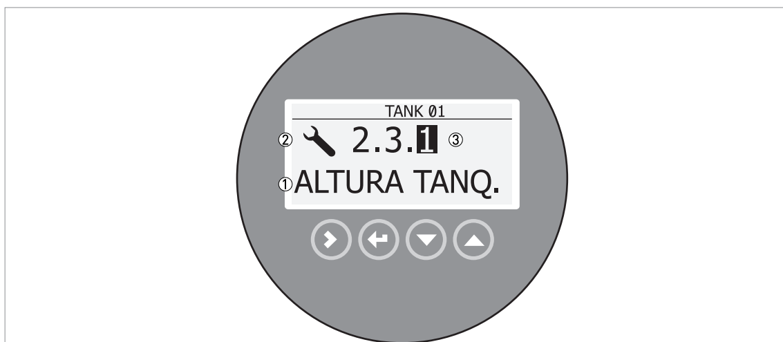
Figura 5-2: Información que aparece en la pantalla local en el modo de configuración
