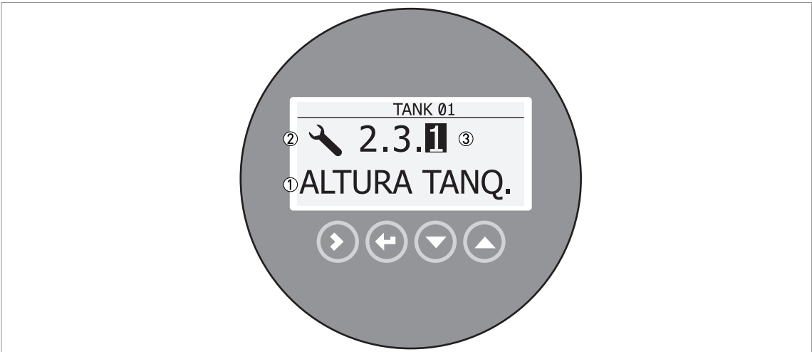
Figura 6-1: Información que aparece en la pantalla local en el modo de configuración
