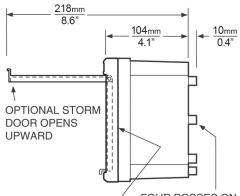
GASKET BETWEEN CASE AND HINGED FRONT COVER. FRONT COVER HINGES DOWNWARD.
