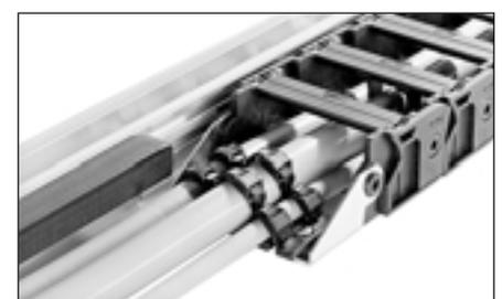
Peine sujeta-cables montada en una cadena portacables.
