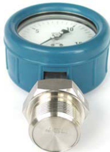
Manómetro modelo 232.50.100 con goma de protección para la caja y separador modelo 990.36 montaje directo al instrumento. Ejecución especial con disco de protección
