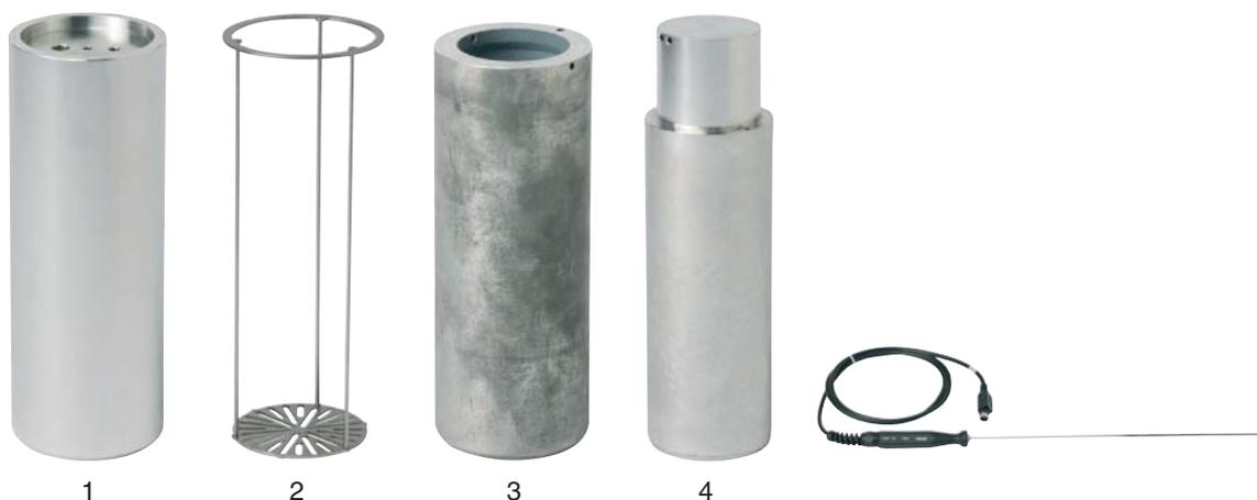
1. El casquillo interior tiene varios taladros que sirven de alojamiento para las sondas de temperatura a calibrar y para un termómetro adicional de referencia del cliente que permite una calibración de comparación. El bloque se calienta o se enfría hasta alcanzar la temperatura de calibración deseada. Cuando la temperatura es estable, se comparan las sondas de temperatura a calibrar con el termómetro de referencia. La calibración es la documentación de esta comparación.
