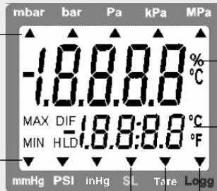
Indicación principal Valor de medición del canal 1 (CH1)
