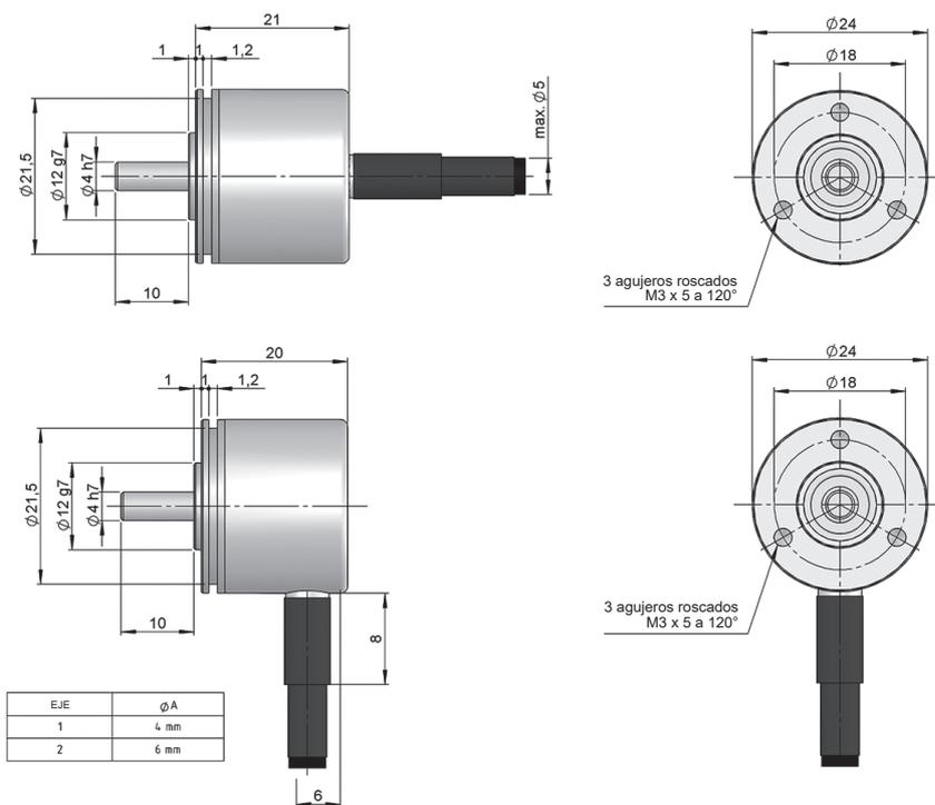
Dibujo eje tipo 1, conexión tipo 1/2
