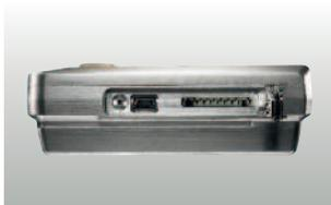
Conector lateral mini USB y ranura para tarjeta SD
