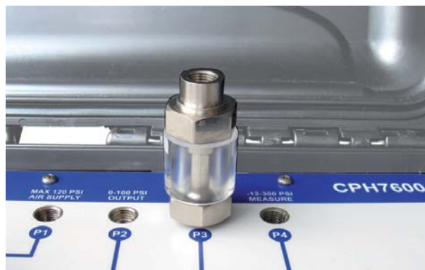
Wally Box III, modelo CPH7600 con filtro atrapador de contaminantes montado
