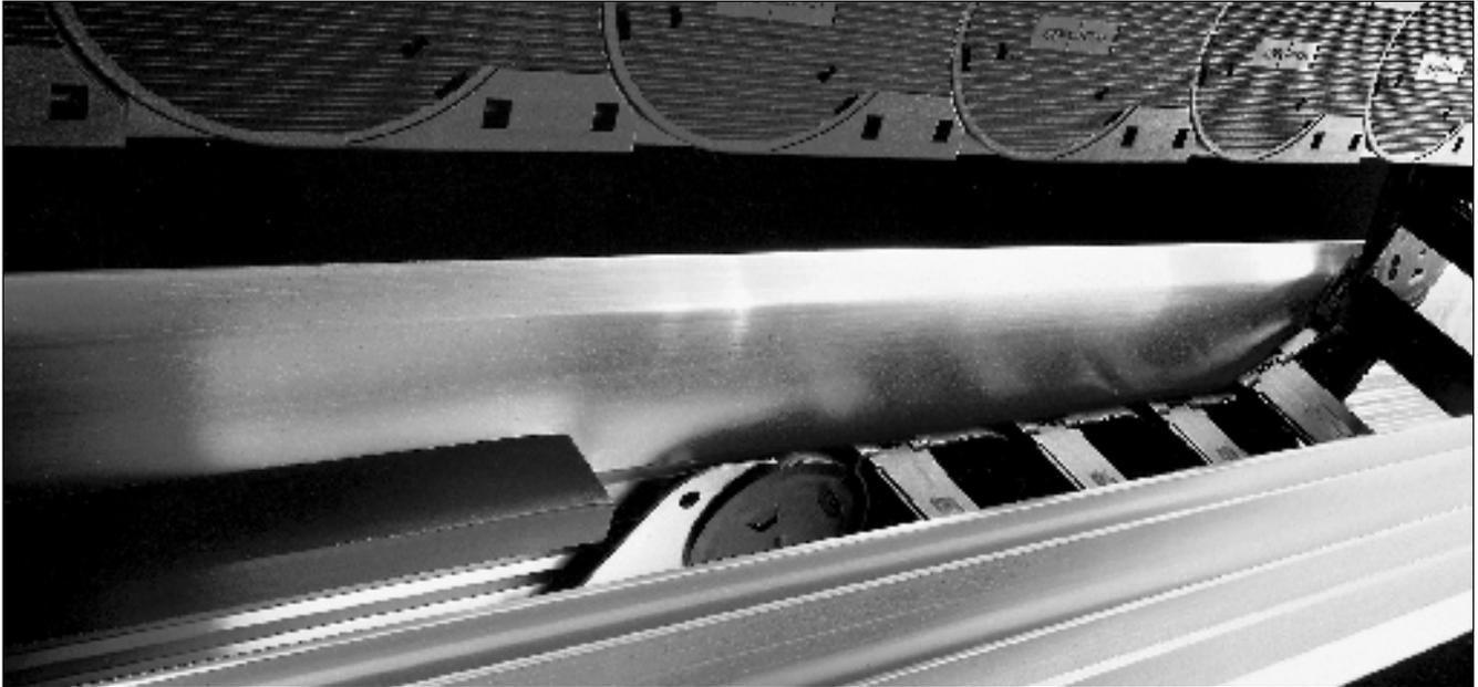
Los sistemas de canaletas para cadenas portacables sirven de apoyo para recorridos cortos y también como conducto de guía para recorridos largos. Si no se utiliza una canaleta, no se garantiza un apoyo correcto de los eslabones. Esto se aplica sobre todo en el caso de radios de curvatura grandes, ya que no se dispone de guía lateral. En la mayoría de las aplicaciones, los
