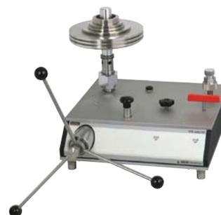
Balanza de presión para presiones máximas, modelo CPB5000HP
