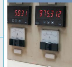
La series INDUSTRIALES de medidos digitales (Serie B, Serie K, Serie M y Serie S) se fabrican con arquitectura modular. Así se pueden montar los mismos módulos en diferentes unidades de la serie.
