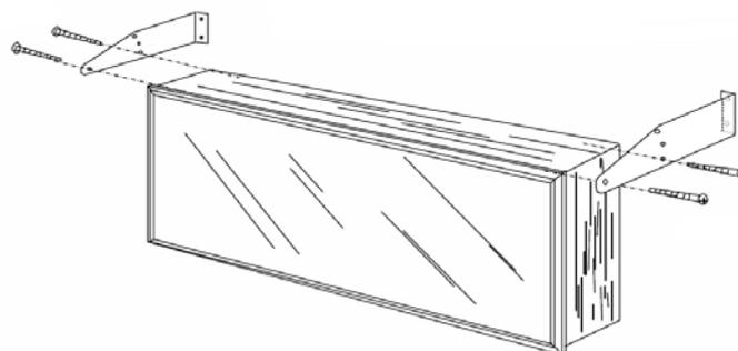
*Opción SMW para montaje tipo pared de los instrumentos de la serie BDF de displays gigantes. Unidades muy robustas tanto física como eléctricamente, apropiadas para todo tipo de entornos industriales.*
