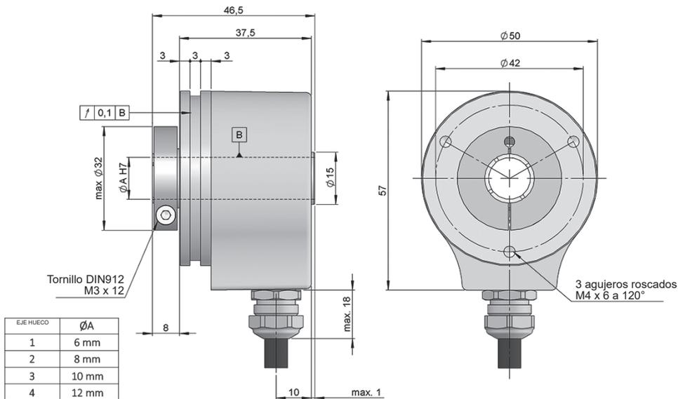
Dibujo opción mecánica tipo 1, eje hueco tipo 4, conexión tipo 1
