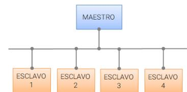
Esquema de comunicación con MODBUS
