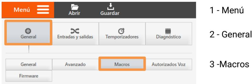
Las macros pueden crear comandos fácilmente memorizables para el usuario. Por ejemplo, el comando para activar una salida digital podría tomar la forma  $OUT0=1$  siguiendo la sintaxis del equipo. Sin embargo, es posible mediante las macros generar un comando de usuario con texto "Encender Caldera" que evidentemente resulta mucho más fácil de recordar. Existe una segunda aplicación para las macros que es la de crear conjuntos de comandos que se ejecutaran desde una acción.
