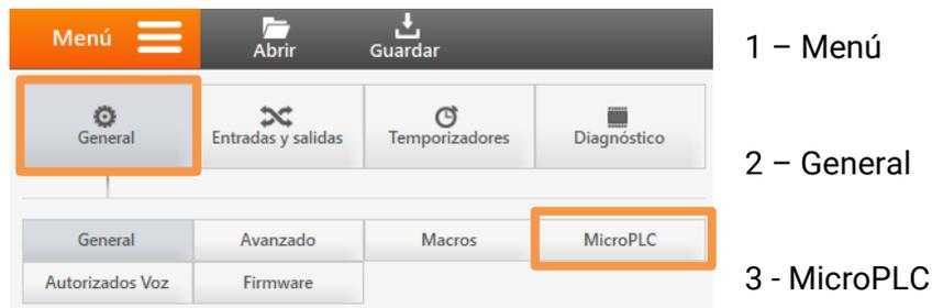
El **MicroPLC** es un lenguaje de programación textual propietario que basa su funcionamiento en la lógica de contactos (Ladder logic), una lógica de programación muy extendida dentro los autómatas programables. El lenguaje **MicroPLC** se ha desarrollado para que sus equipos tengan un enorme potencial de programación.
