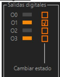
Muestra el nombre y el estado de las salidas digitales configuradas y permite activarlas y desactivarlas manualmente. En la columna derecha se monitoriza el estado de la salida, (naranja→activada, gris→desactivada). En la parte izquierda se utiliza para cambiar manualmente el estado de la salida.
