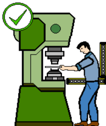
Protección horizontal y vertical
