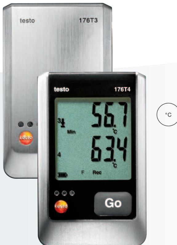
Comprobar si se han mantenido las temperaturas legalmente prescritas en los procesos de fabricación es muy habitual y muy importante en múltiples aplicaciones. En estos casos, el testo 176 T3 puede medir y registrar temperaturas hasta en 4 puntos de medición diferentes. Gracias a su fabricación en carcasa metálica y su amplia gama de sondas acoplables, este data logger está preparado para su uso en infinidad de tareas.
