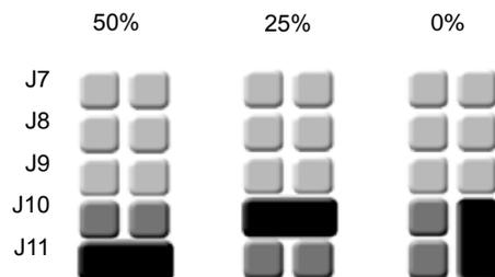
Nota - Seleccionar 0% para deshabilitar el preoffset. Seleccionar 25% o 50% si el offset requerido no puede conseguirse con el potenciómetro de offset frontal.
