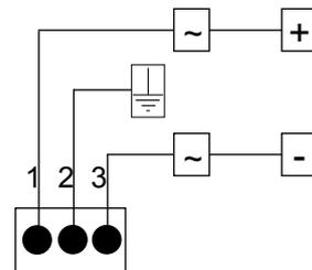
Conexión a tierra - Aunque se ofrece un terminal para la conexión del cable de tierra, esta conexión es opcional. El equipo no necesita de esta conexión para su correcto funcionamiento ni para cumplir con la normativa de seguridad.
