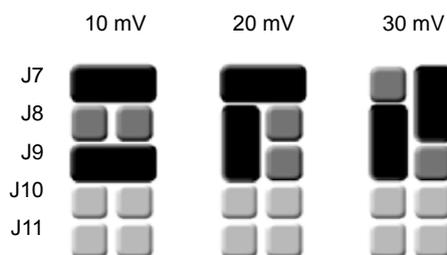
Nota - las células de carga se caracterizan por una señal de salida proporcional a la tensión de alimentación. Valores típicos son 1mV/V, 2mV/V y 3mV/V. Para una alimentación de 10V, los valores anteriores se asocian a los rangos 10mV, 20mV y 30mV.
