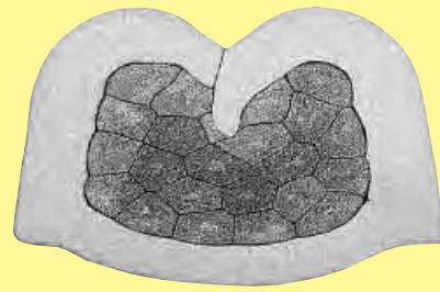
Sección transversal del contacto estampado con forma de B
