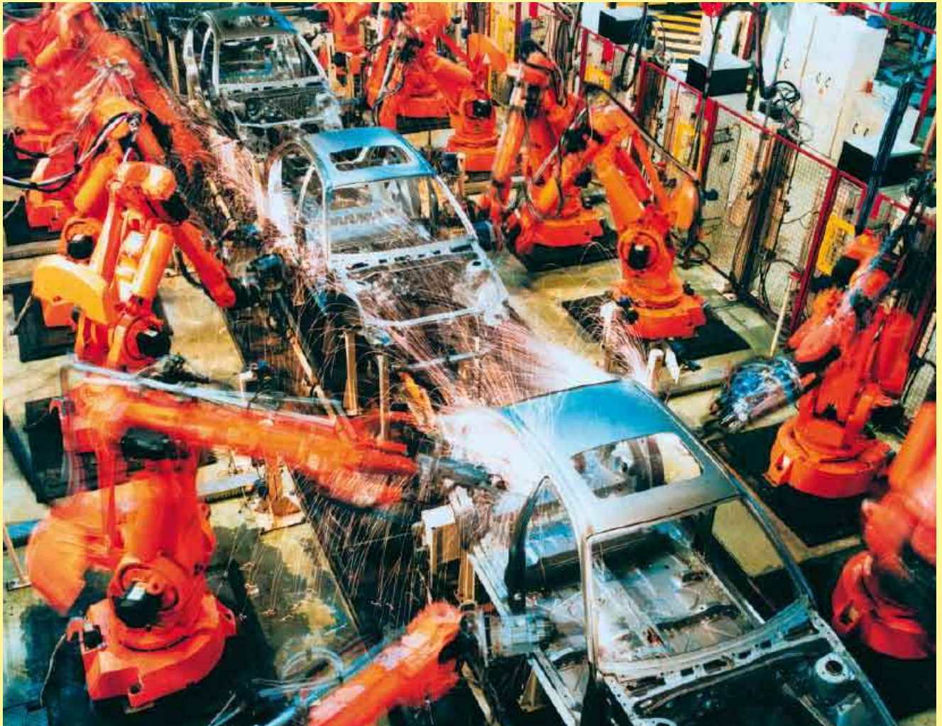
Robots de soldadura en la producción de automóviles ABB Robotics AB, Västerås, Suecia
