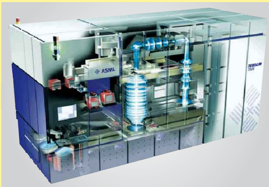
Escáner de oblea TWINS CAN ASML, Lithography, Veldhoven, Países Bajos
