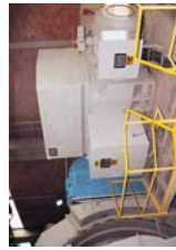
3800kW, 6 polos, 660V, carcasa MAF630 Aplicación: Molino
