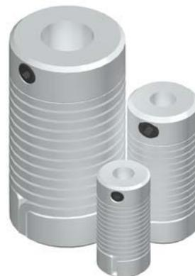
Los SPRING-FLEX se basan en la utilización de un resorte helicoidal como elemento elástico de transmisión. Estos resortes se construyen en acero y de sección plana. Los extremos del resorte están diseñados para evitar la rotación del mismo.
