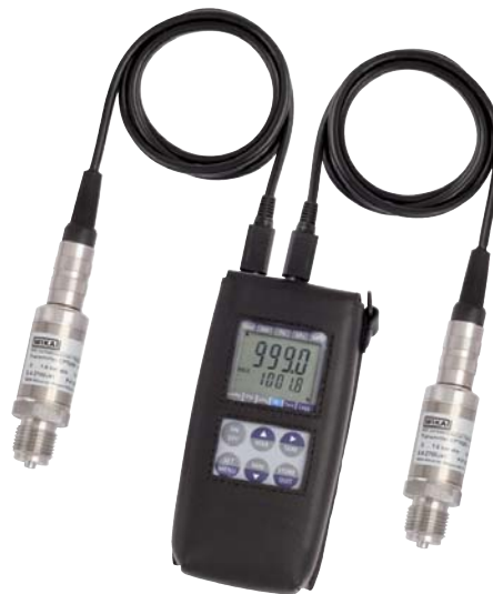
Manómetro portátil modelo CPH6210-S2 con dos sensores de presión de referencia modelo CPT6210
