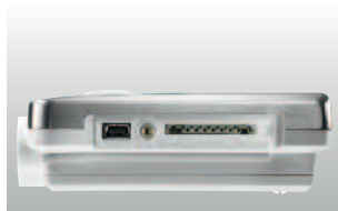
Conector para mini USB y zócalo para tarjeta SD en el lateral
