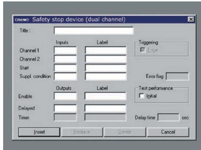
Beispiel eines funktions-orientierten Menüs für NOT-HALT-Befehlsgeräte
