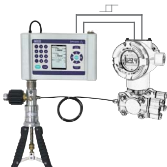
Con asistente de prueba de interruptor de presión
